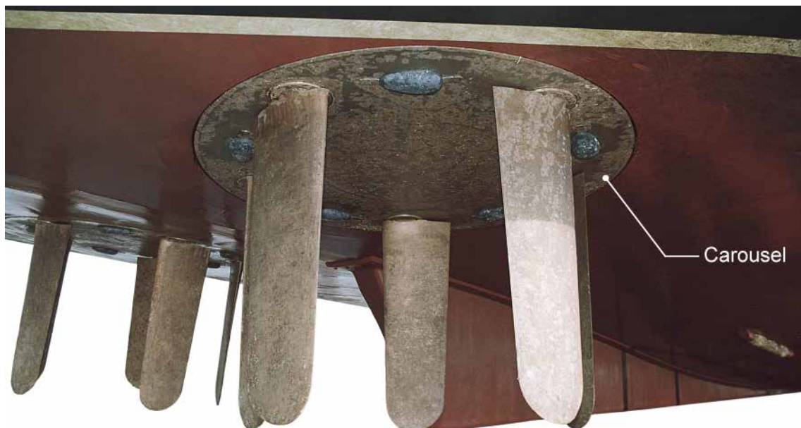
Fig 10-4. A Voith-Schneider propulsion unit
