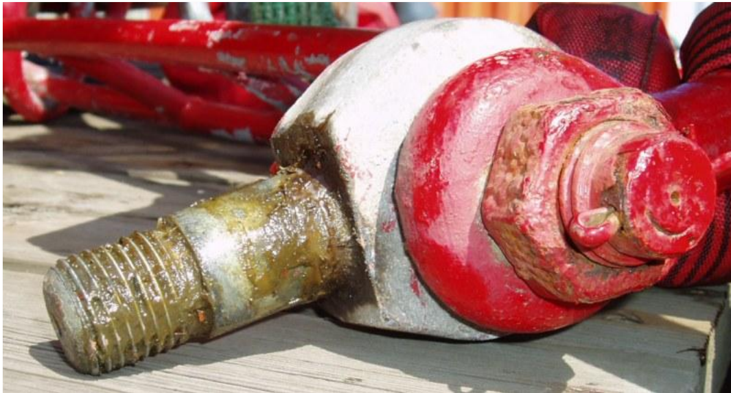
Vis de l'émérillon tribord après l'accident / Starboard swivel screw after the accident
