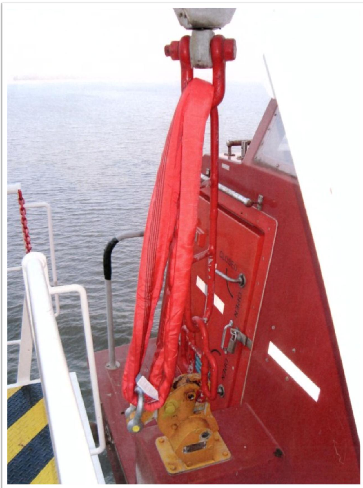
Ceinture de liaison entre émerillon et croc de largage (Fall Protection Device)
